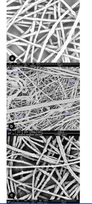
**[Table/Fig-3]:** (500 X) Photomicrographs of surgical mask layers. a) layer 1; b) layer 2; c) layer 3.
